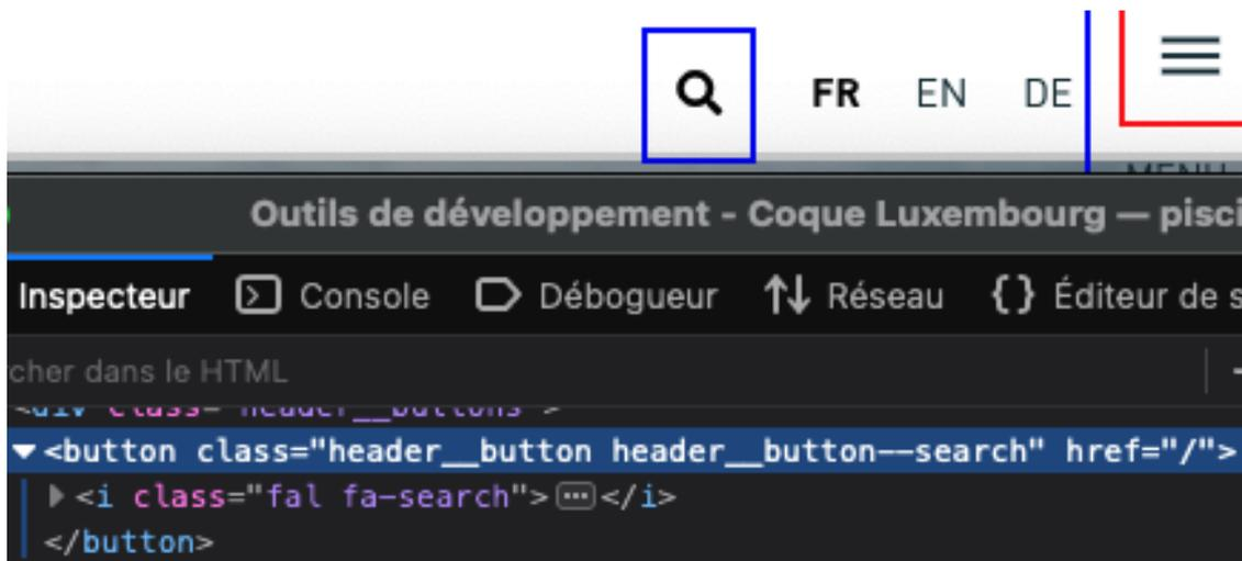
Dans l'en-tête du site, le bouton `<button>` "loupe" permettant d'afficher le module de recherche, possède un attribut `href="/"` et ne possède pas de nom accessible.
