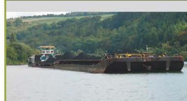
Généralement composé d'une unité motrice et de deux barges, le «convoi poussé» offre une grande flexibilité opérationnelle du fait de l'indépendance des unités de transport du moyen de propulsion.
