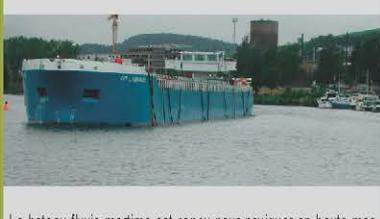
Le bateau fluvio-maritime est conçu pour naviguer en haute-mer et sur les voies d'eau à grand gabarit (jusqu'à 3,50 m de tirant d'eau). L'avantage qu'il peut offrir est d'assurer un transport sans rupture de charge sur des trajets comprenant des parcours maritimes et fluviaux.
