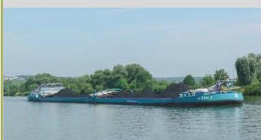
C'est l'automoteur classique à cale sèche. Il offre des cales volumineuses et peut naviguer sur les voies navigables d'un gabarit supérieur à la classe IV.
